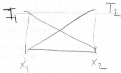
$$\frac{\alpha_2 h^{(e)}}{2} + \frac{\alpha_3 (h^{(e)})^2}{4} = T_2^{(e)} - T_1^{(e)}$$
