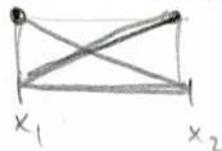
$$\int_{x_1}^{x_2} \begin{bmatrix} \frac{x_2-x}{x_2-x_1} & \frac{x-x_1}{x_2-x_1} \end{bmatrix} \begin{bmatrix} k_1^{(e)} \\ k_2^{(e)} \end{bmatrix} \begin{pmatrix} -\frac{1}{h^{(e)}} & \frac{1}{h^{(e)}} \\ \frac{1}{h^{(e)}} & -\frac{1}{h^{(e)}} \end{pmatrix} dx \begin{pmatrix} T_1^{(e)} \\ T_2^{(e)} \end{pmatrix}$$
